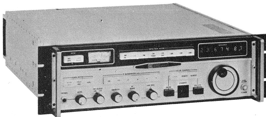
Fig. 2 - Questo ricevitore altamente professionale della Watkins-Johnson, per la gamma 500 kHz ÷ 30 MHz, possiede i seguenti filtri inseribili tramite commutatore: 0,2, 0,5, 1, 2, 3, 4, 6, 8, 12 e 16 kHz.
